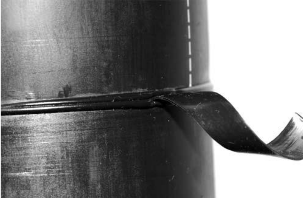
شکل ۱۳- وضعیت ظاهری غیرقابل پذیرش جوش لب به لب
