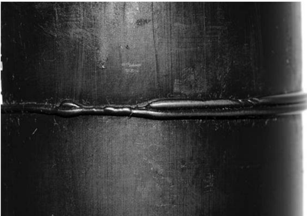
شکل ۱۳- وضعیت ظاهری غیرقابل پذیرش جوش لب به لب
